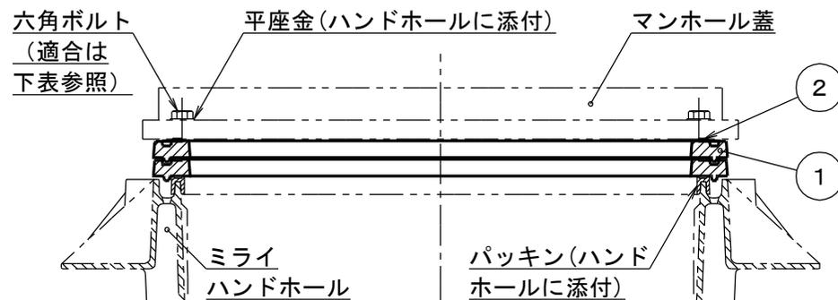
施工状態参考図 (製品2枚重ね時)
